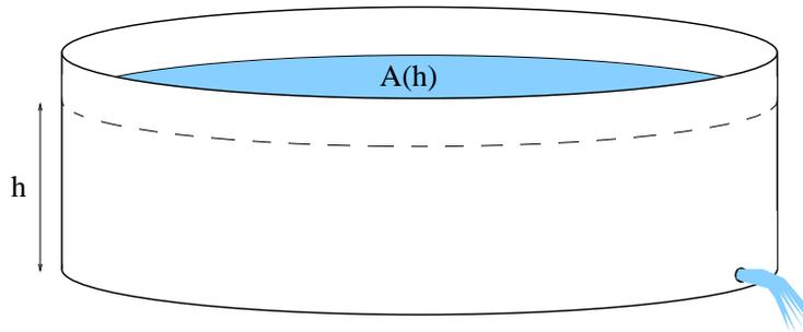
Au temps  $t = 0$ , une piscine de 2 mètres de rayon contient 1 mètre d'eau au dessus de l'orifice. La constante  $g$  vaut approximativement  $9,8 \text{ m}\cdot\text{s}^{-2}$  et la constante  $k$  vaut  $0,01 \text{ m}^2$ .
