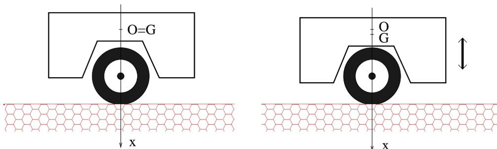
**Exercice 6** – On souhaite étudier la suspension d’une remorque. Le centre d’inertie  $G$  de la remorque se déplace sur un axe vertical ( $Ox$ ) dirigé vers le bas (unité : le mètre); il est repéré par son abscisse  $x(t)$  en fonction du temps  $t$  exprimé en secondes. On suppose que cette remorque à vide peut être assimilée à une masse  $M$  reposant sans frottement sur un ressort.
